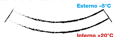
Deformazione invernale di un pannello non aderente
