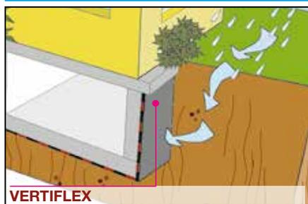
**VERTIFLEX POLIESTERE** è la membrana che INDEX ha progettato per risolvere i problemi applicativi di impermeabilizzazione dei muri controterra, dove le membrane, principalmente destinate al rivestimento delle coperture, possono presentare maggiori difficoltà che ne impediscono il corretto svolgimento e adesione durante la fase di sfiammatura.
