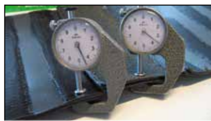
Lo spessore del sormonto è inferiore a quello delle strisce garantendo la massima stabilità ai pannelli isolanti posati a cavallo del sormonto
