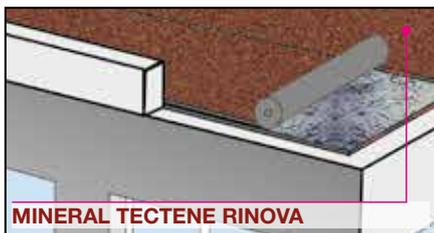
**MINERAL TECTENE RINOVA EP** è la membrana termoadesiva autoprotetta messa a punto da INDEX per rinnovare e prolungare la vita del vecchio manto bituminoso degradato ma che ancora non presenta infiltrazioni. In tal caso gli strati sottostanti non sono ancora inumiditi ed è quindi possibile incollare la membrana in totale aderenza a fiamma sul vecchio manto senza il rischio di intrappolare umidità e con il vantaggio di recuperare e rinforzare la funzione di tenuta all'acqua del vecchio manto.
