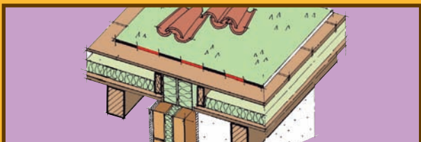
Isolamento acustico dai rumori aerei e isolamento termico dei tetti in legno
