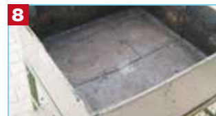
8 Faccia superiore di DEFEND H dopo il test
