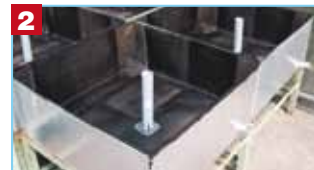
2 Vasche di prova impermeabilizzate con DEFEND H
